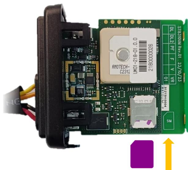
**⚠️ Atenção:** Para o modelo **ST8310UM** recomendamos o uso do SIM Card **tipo Nano (4FF)**. A utilização de SIM Card adaptados e de outros formatos podem danificar o equipamento, levando à perda de garantia.
