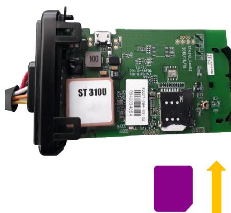
**Atenção:** Para os modelos **ST8310U**, **ST8310W** e **ST8310R** recomendamos o uso do SIM Card **tipo Micro (3FF)**. A utilização de SIM Card adaptados e de outros formatos podem danificar o equipamento, levando à perda de garantia.
