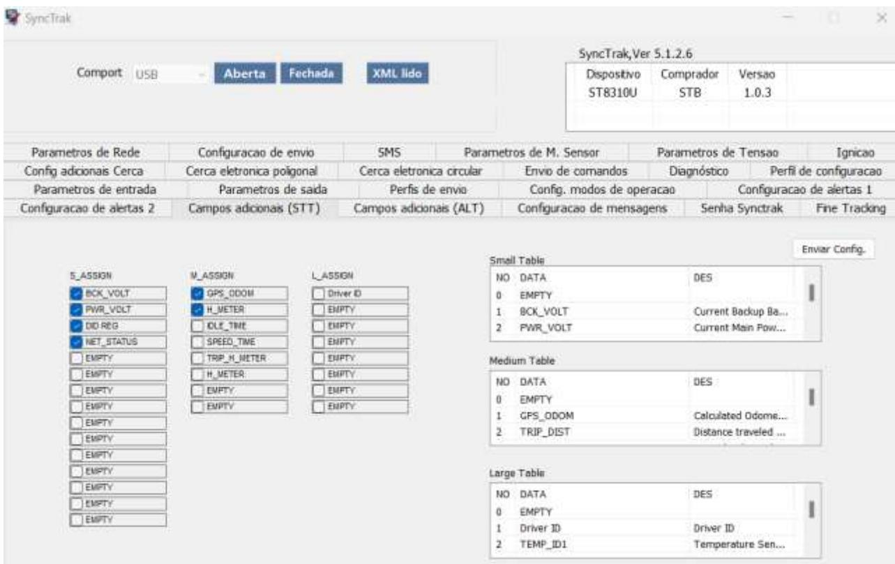
No **ST8310UM** é possível configurar os dados e as informações adicionais que serão transmitidos nas posições do dispositivo. Esta configuração é realizada através do menu **Campos Adicionais (STT)** do configurador Synctrak. Existem 3 classificações de informações adicionais que podem ser adicionados a posição e classificamos conforme as tabelas, small table, medium table e large table.
