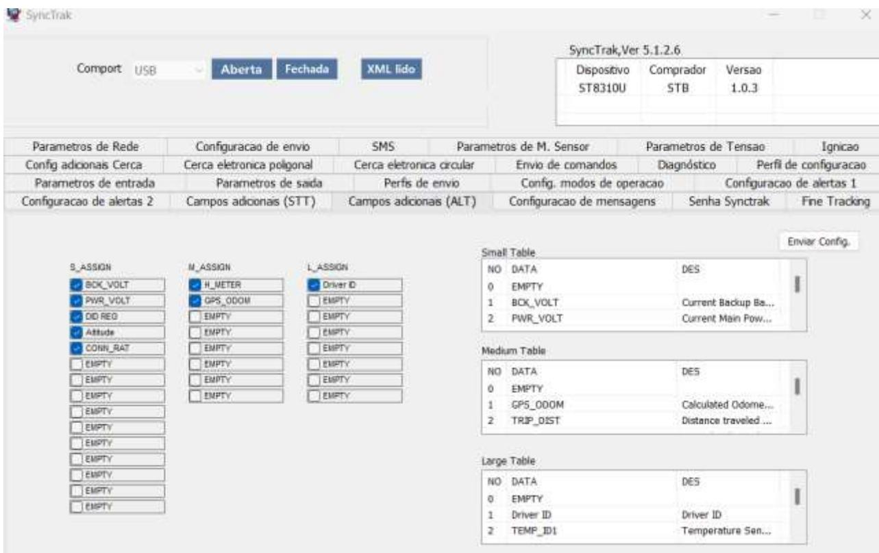
No **ST8310UM** é possível configurar os dados e as informações adicionais que serão transmitidos nos alertas do dispositivo. Esta configuração é realizada através do menu **Campos Adicionais (ALT)** do configurador Synctrak. Existem 3 classificações de informações adicionais que podem ser adicionados aos alertas e classificamos conforme as tabelas, small table, medium table e large table.
