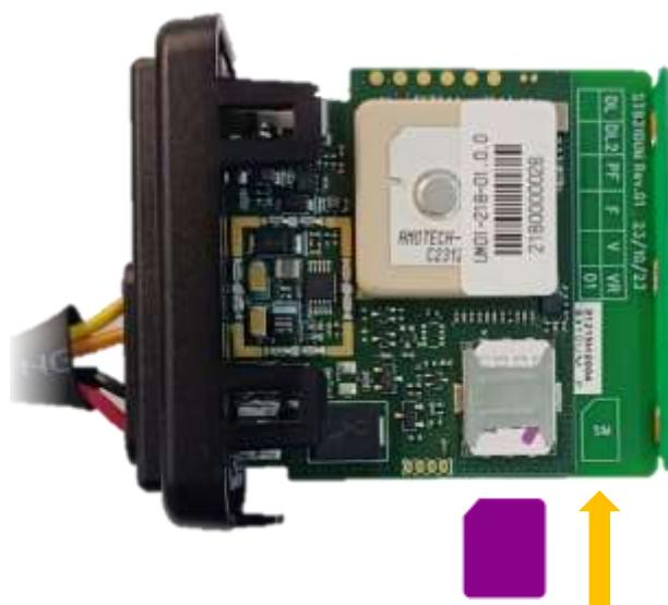
**⚠️ Atenção:** Recomendamos o uso do SIM Card **tipo Nano (4FF)**. A utilização de SIM Card adaptados e de outros formatos podem danificar o equipamento, levando à perda de garantia.
